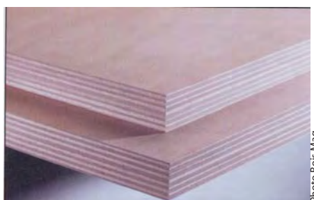
Dans les panneaux à base de bois, comme ce contreplaqué, la colle peut atteindre 10 % de la masse totale du produit.
