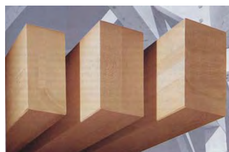
les contrecollés sont des lamellés collés à 2, 3 ou 4 plis et sont utilisés en éléments de charpente ou de menuiserie de faible section
