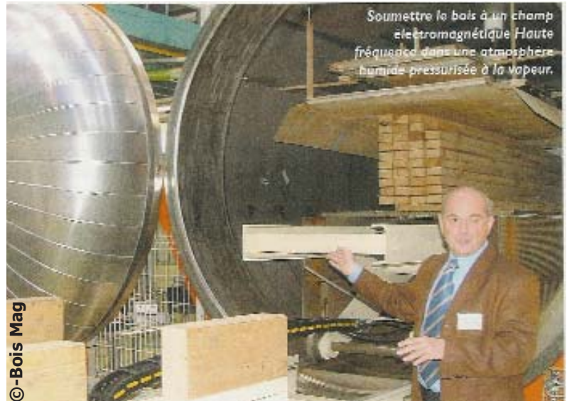
La forme particulière des électrodes permet d'optimiser le séchage du bois.
